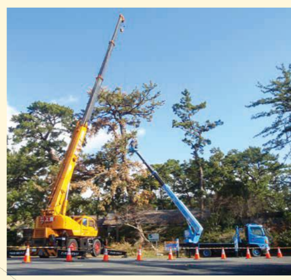
クレーンと高所作業車を用いた伐倒駆除 Crane and cherry picker being used to fell and remove trees
